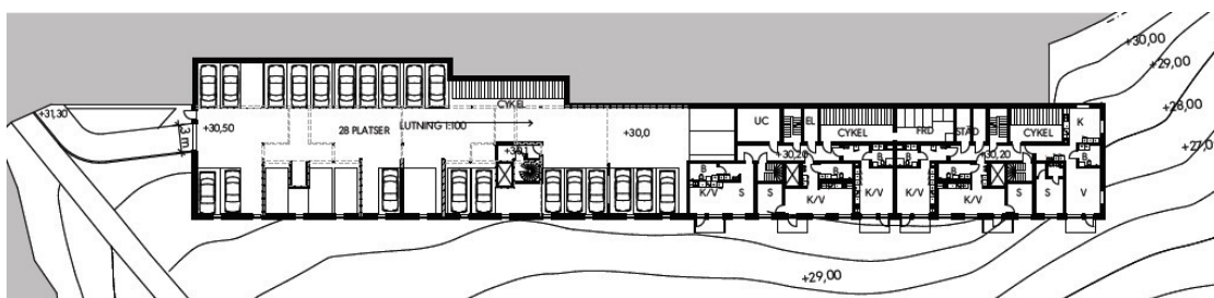
Figur 13: Koncept för Parkeringsgarage/ souterrängvåning som innehåller parkeringsplatser och bostäder. Parkeringsgaraget angörs via Ejdervägen. Illustration: Bergkrantz arkitektur
